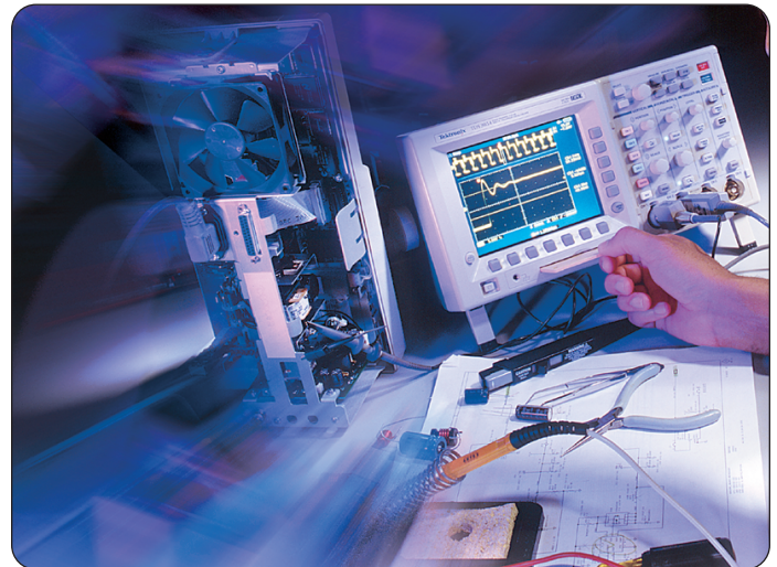
▶ 그림 4. 250 W D급 전력 공급기의 고조파를 분석하는 TDS3000B. 세 번째 고조파 (180 Hz)가 IEC61000-3-2로 850 mA를 초과하는 것을 나타내는 커서.
